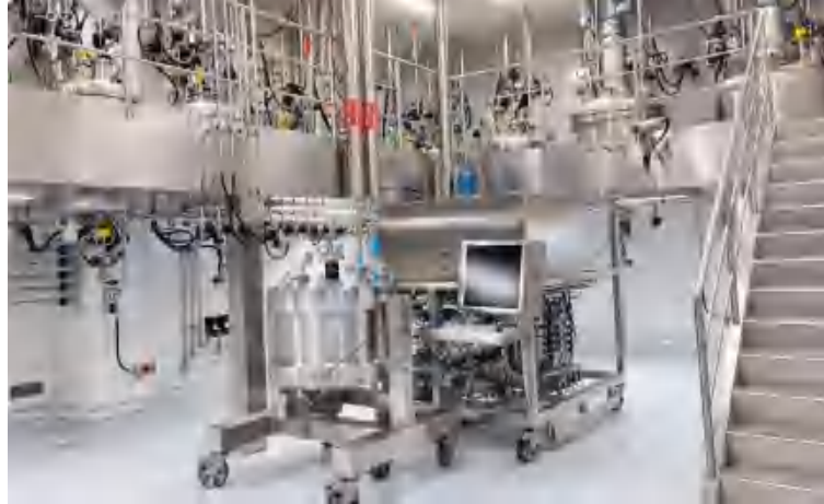
常州基地寡核苷酸生产车间1800毫摩尔合成仪（图片来源：合全药业）
